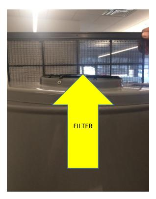
TAKE THE FILTER OUT THE TOP CENTER PORTION OF THE HEATER
